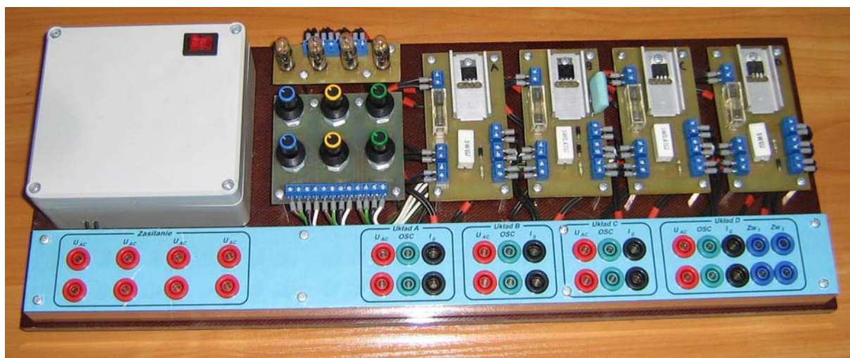
Rys. 6.1. Widok makiety dydaktycznej z tyrystorami i triakami
