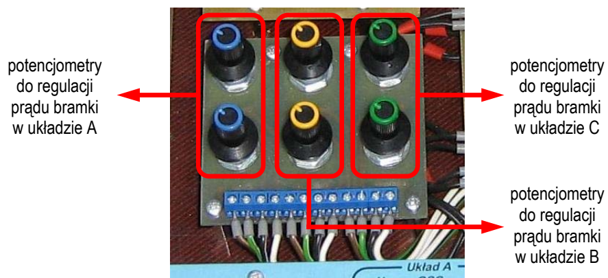
Rys. 6.4. Moduł z potencjometrami do regulacji zgrubnej i dokładnej prądu bramki
